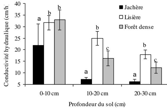
**Figure 5.** La conductivité hydraulique moyenne ( $n=9$ ) des couches 0-10, 10-20 et 20-30 cm de profondeur d'un ferralisol de la série Yakonde sous la jachère herbeuse, la lisière et la forêt dense en R.D. Congo. Les barres représentent les écarts types de la moyenne et les lettres minuscules différentes indiquent une différence significative entre les moyennes (Test U Mann Whitney).
