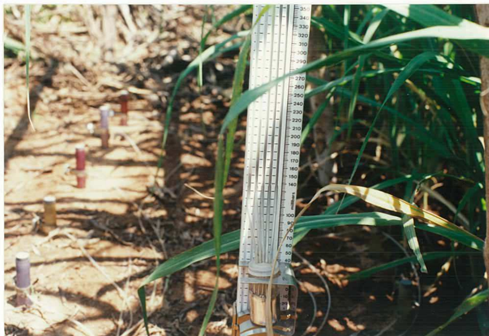
PHOTO 2 - Batterie tensiométrique comprenant le système de lecture du potentiel total et ses 5 cannes tensiométriques.
