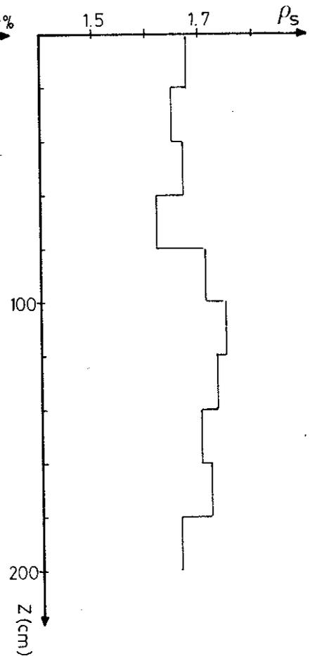
Fig.5\_ ANA.If 1700 : Profil des densités apparentes sèches.
