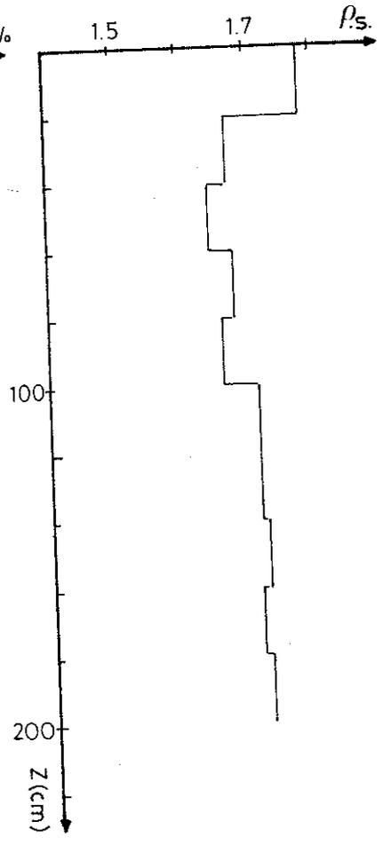
Fig.3\_ ANA.If 1485: Profil des densités apparentes sèches.
