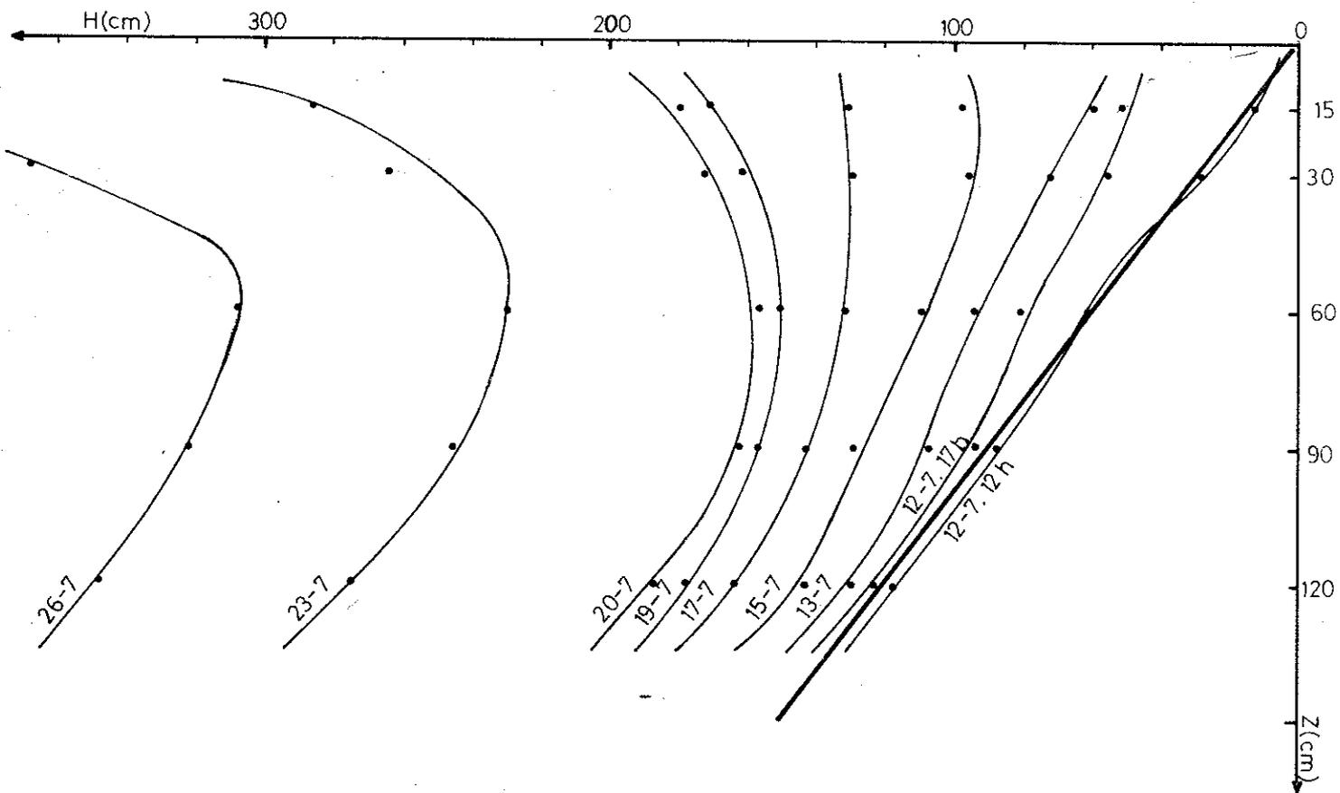
Fig.17 \_ ANA.If 1700 : Variations du potentiel total en fonction de la profondeur  $H = f(Z)$
