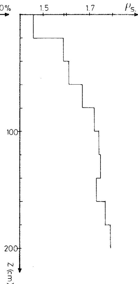
Fig.7\_ ANA.I déf. : Profil des densités apparentes sèches.
