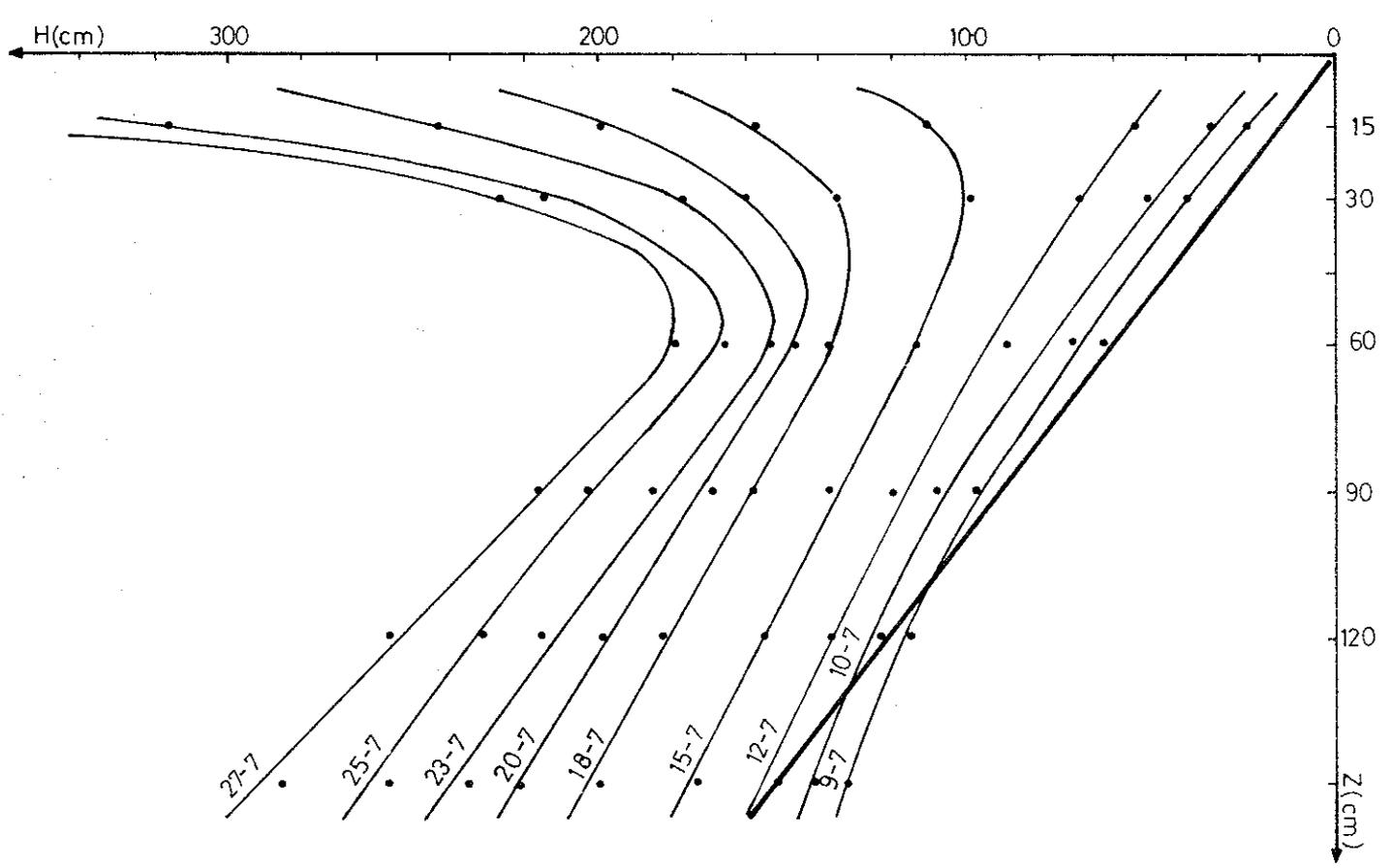
Fig.12 - ANA.If 1485: Variations du potentiel total en fonction de la profondeur.  $H = f(Z)$
