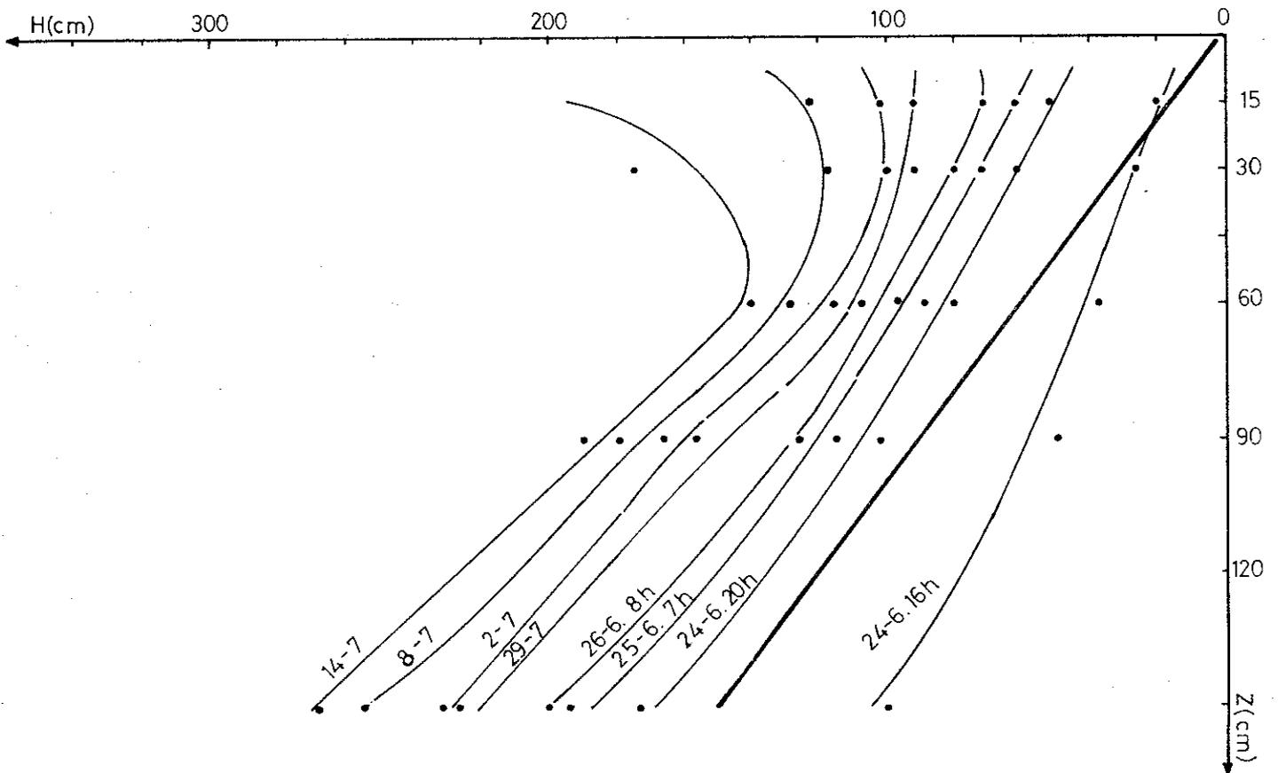
Fig.22- ANA.I Déf. : Variations du potentiel total en fonction de la profondeur  $H = f(Z)$
