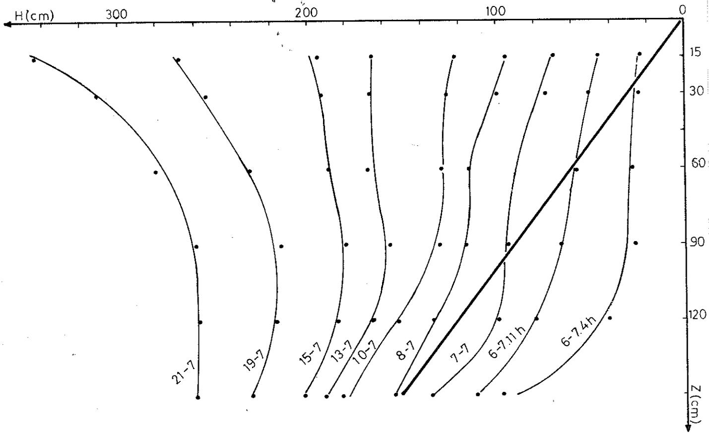
Fig. 26\_ ANA. Ib 900 : Variations du potentiel total en fonction de la profondeur.
