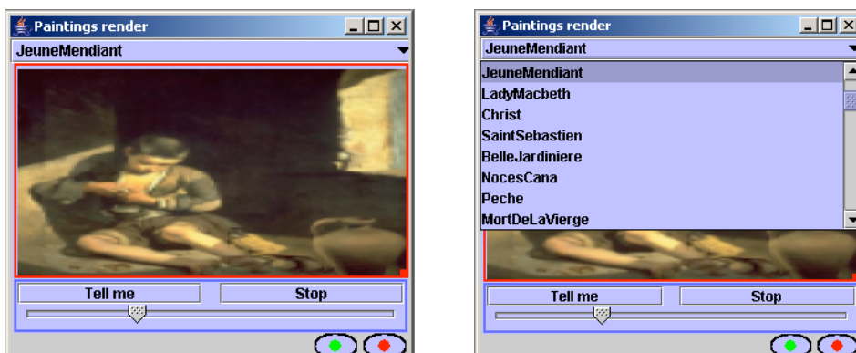
Figure 105 : Au-delà d'un certain rétrécissement, la liste se compacte en un menu déroulant qui rejoint le traditionnel bandeau de la fenêtre.
