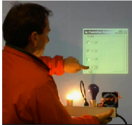
Figure 36 : Phidget de manipulation d'une lampe : l'utilisateur agit sur une IHM numérique (la fenêtre) pour piloter le monde physique (allumer la lampe).
