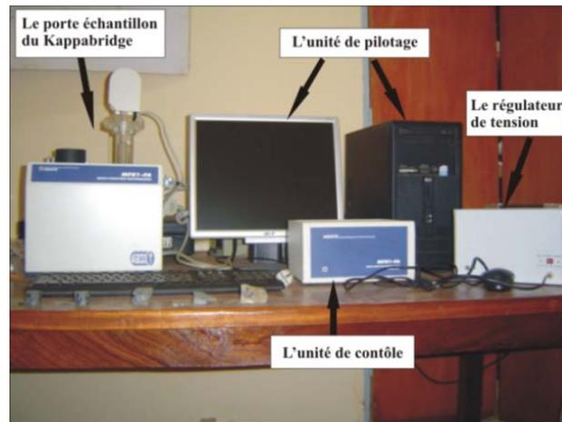
Figure 16 : Susceptomètre Kappabridge MFK1-FA et ses unités de contrôle (source [www.agico.com](http://www.agico.com))
