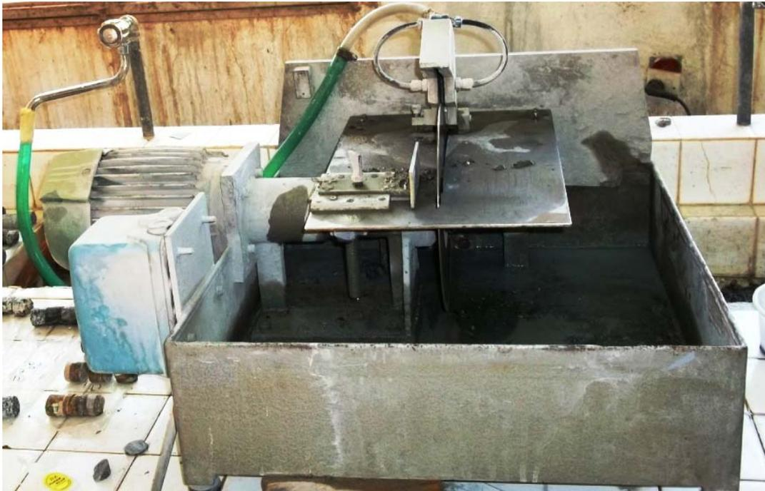
Figure 15 : Tronçonneuse permettant de découper les carottes
