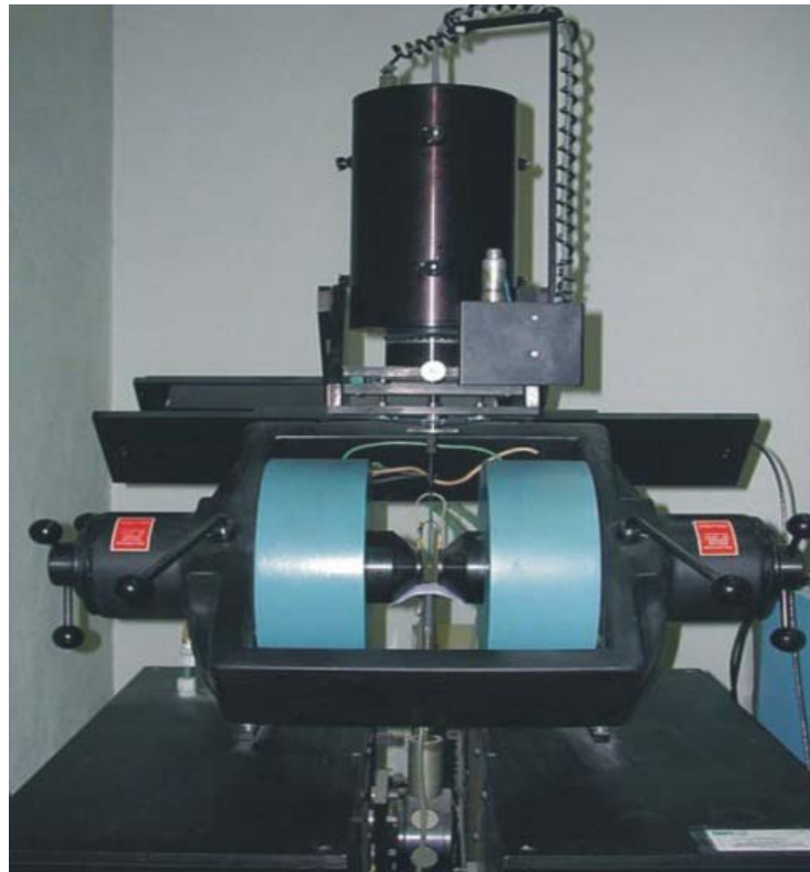
Figure 18 : Exemple de magnétomètre à échantillon vibrant VSM permettant de mesurer l'aimantation en fonction du champ appliqué sur une large gamme de champ ( \pm 1T ). Source http://auracenter.fr/Art/D%C3%A9tection.html
