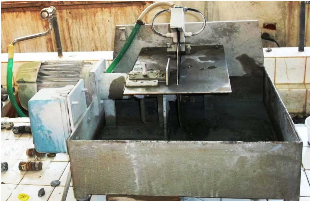
Figure 15 : Tronçonneuse permettant de découper les carottes
