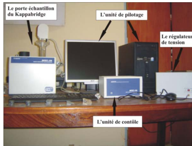
Figure 16 : Susceptomètre Kappabridge MFK1-FA et ses unités de contrôle (source www.agico.com )
