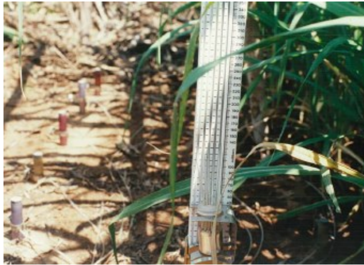
Figure 23. Vue partielle des cannes tensiométriques occupant une partie d'un inter-rang sur le plot B7 de la SIRANALA (photo R. Gaudin). Ici vue d'une seule batterie de tensiomètres. Le dispositif comporte 3 batteries de part et d'autre d'une ligne de référence
