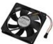
L'électronique, ça chauffe et pas qu'un peu. Pour éviter une température digne des enfers à l'intérieur, des ventilateurs et radiateurs sont placés stratégiquement pour refroidir les composants.
