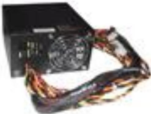
L'alimentation, c'est la centrale électrique de l'ordinateur. Elle reçoit le courant 230 Volts d'EDF et le converti en 12 Volts. Des câbles colorés en sortent pour aller alimenter chaque élément de l'*unité centrale*.
