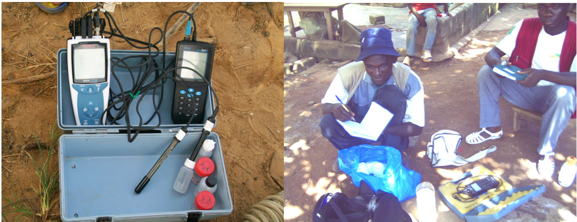
Planche 6: Mesure des paramètres physico-chimiques in situ d'un puits de la ville de Yamoussoukro (Quartier Dioulakro).
