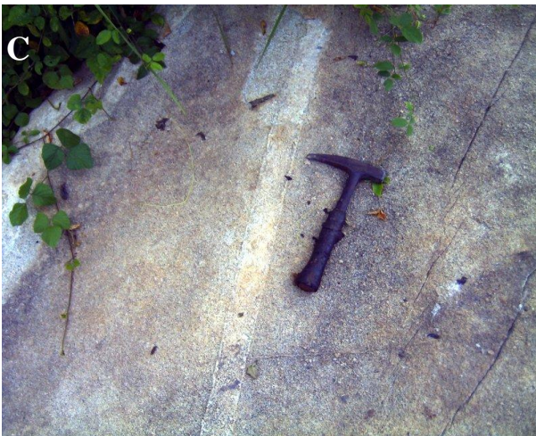
Photo C : Granite affleurant altéré traversé par un filon de quartz et de fractures
